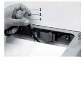
1.ALIMENTACIÓN 24 V+ 2.ALIMENTACIÓN 24 V- 3.TOMA DE TIERRA
